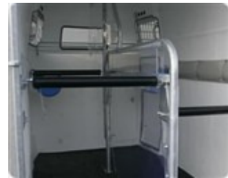
Sistema di regolazione della barra al petto (altezza pony o cavallo)
