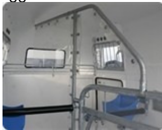
Testiera trasparente o nera progettata per separare i cavalli
