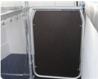
Pannello frontale (progettato per impedire ai puledri di passare sotto la barra)
